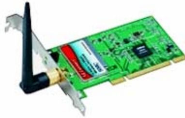
Tarjeta de red WiFi-PCI para conexión de los PC que son de mesa.
